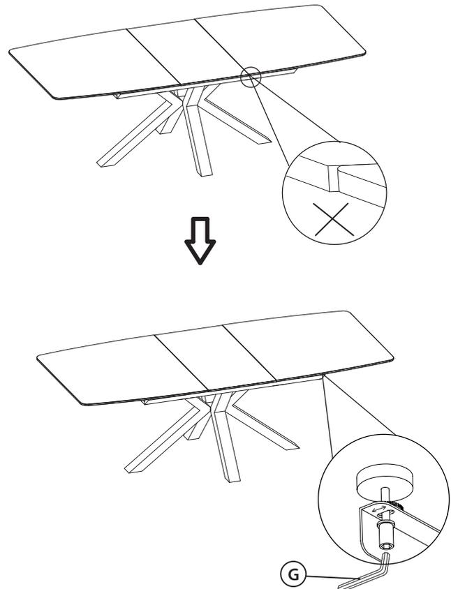
Si les plateaux ou l'allonge ne sont pas bien alignés en largeur, il faut ajuster la largeur en desserrant les vis en dessous, puis ajuster à gauche ou à droite suivant le besoin. Ensuite resserrer les vis.
