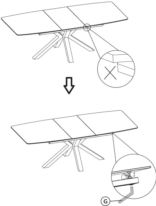
Si l'allonge n'est pas bien alignée en hauteur avec le plateau, il faut ajuster la hauteur de l'allonge en desserrant la vis en dessous, puis en tournant l'écrou vers le haut ou le bas suivant le besoin, et ensuite resserrer la vis.
