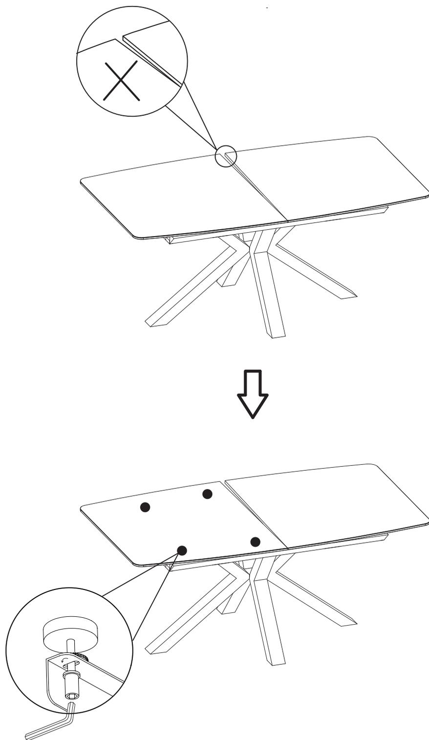
Si les plateaux ne sont pas bien alignés entre eux, il faut ajuster la position d'un plateau en desserrant les vis en dessous, puis ajuster à gauche ou à droite suivant le besoin. Ensuite resserrer les vis.
