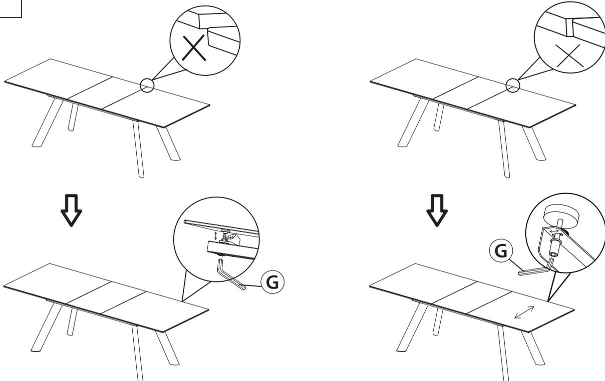
Si l'allonge n'est pas bien alignée en hauteur avec le plateau, il faut ajuster la hauteur de l'allonge en desserrant la vis en dessous, puis en tournant l'écrou vers le haut ou le bas suivant le besoin, et ensuite resserrer la vis.
