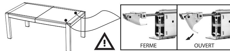
Déverrouiller les coulisses avant d'ouvrir les plateaux
