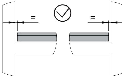
Si une tablette n'est pas bien positionnée, il faut soulever la tablette, remettre les ventouses en place, puis ajuster la tablette en profondeur et en largeur suivant le besoin. Ensuite reposer la tablette.
