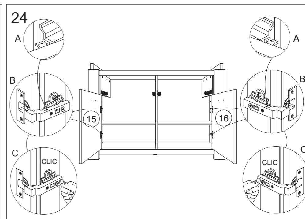
Voor de juiste regeling van de deuren moet U ervoor zorgen dat de kast goed waterpas staat, ook kunt U met de schroeven van de scharnieren 170 de deuren bijregelen. U kan ook de deuren verticaal bijregelen. Ontspan vijzen A en schuif de scharnierblok nr. 171 naar onder of naar boven en schroef terug vast.
