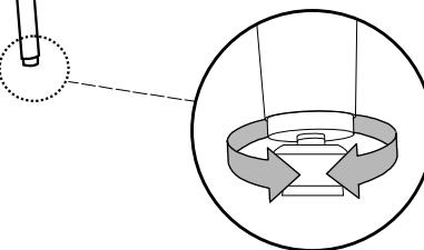
FEET ARE ADJUSTABLE IN HEIGHT BY TURNING
