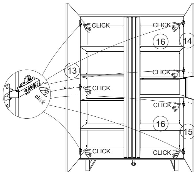
Voor de juiste regeling van de deuren moet U ervoor zorgen dat de kast goed waterpas staat, U kunt met de schroeven van de scharnieren 201 de deuren bijregelen. U kan ook de deuren verticaal bijregelen. Ontspan vijzen A en schuif de scharnierblok nr. 203 naar onder of naar boven en schroef terug vast.
