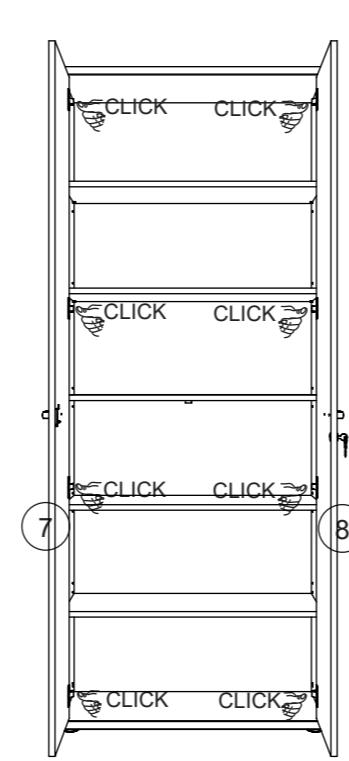
Voor de juiste regeling van de deuren moet U ervoor zorgen dat de kast goed waterpas staat, U kunt met de schroeven van de scharnieren 201 de deuren bijregelen. U kan ook de deuren verticaal bijregelen. Ontspan vijzen A en schuif de scharnierblok nr. 203 naar onder of naar boven en schroef terug vast.
