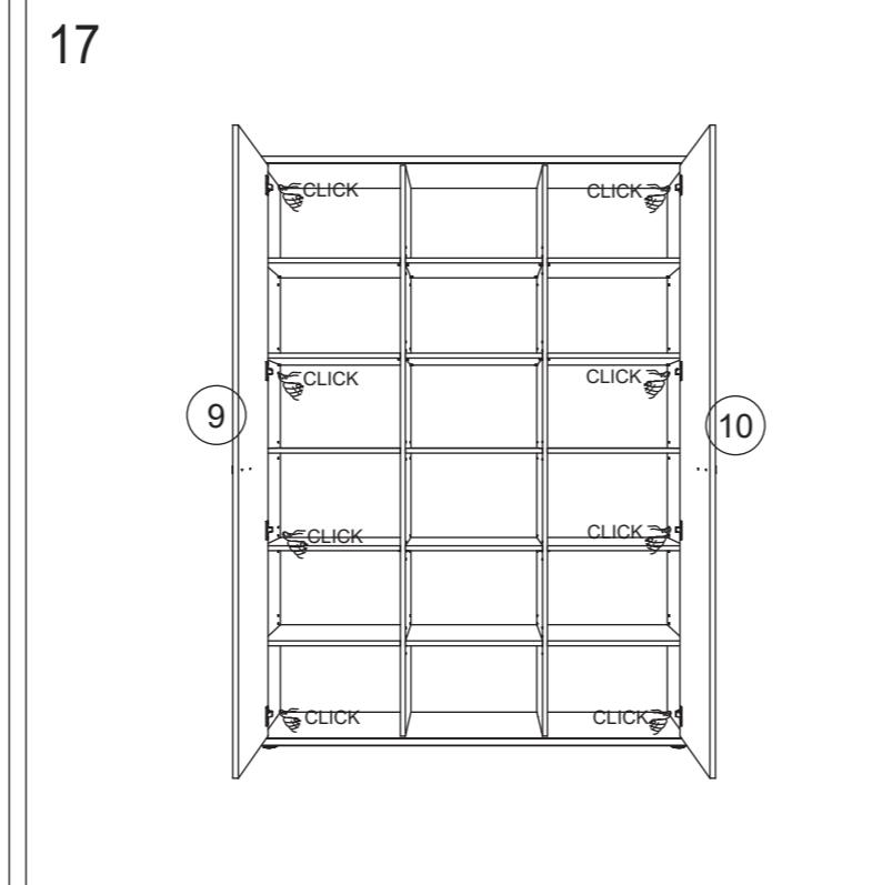
Voor de juiste regeling van de deuren moet U ervoor zorgen dat de kast goed waterpas staat, U kunt met de schroeven van de scharnieren 201 de deuren bijregelen. U kan ook de deuren verticaal bijregelen. Ontspan vijzen A en schuif de scharnierblok nr. 203 naar onder of naar boven en schroef terug vast.
